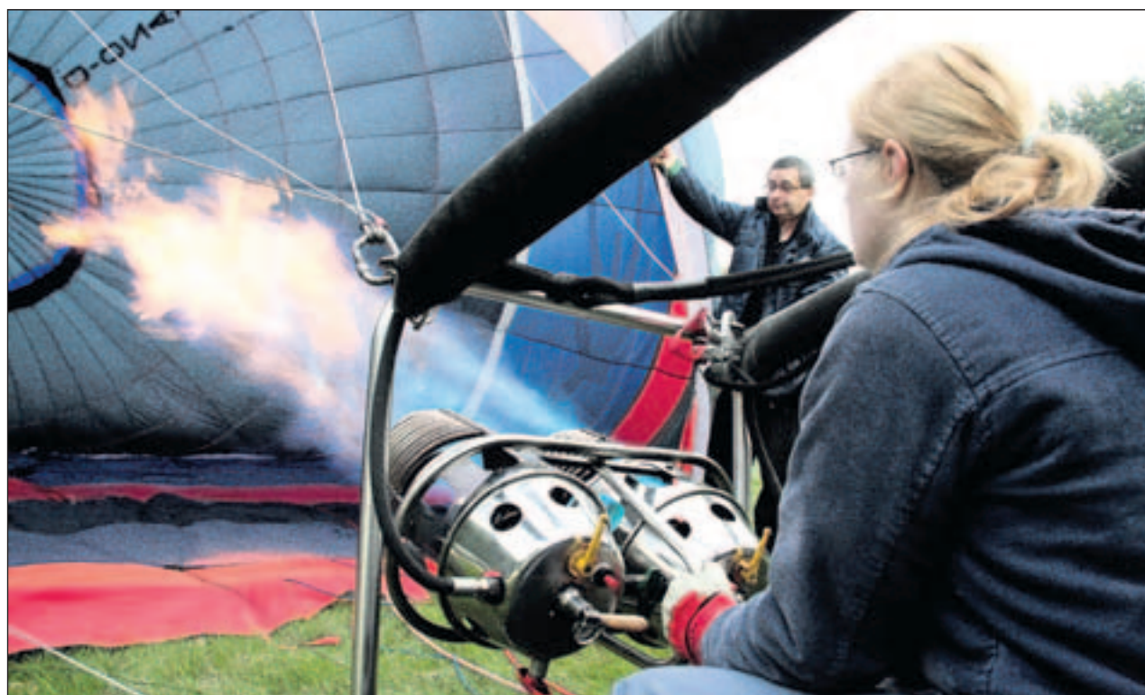
Heiße Sache: Bevor der Ballon aufsteigt, erhitzen zwei Gasbrenner die Luft darin auf rund 70 Grad Celsius. Die beiden Flammen selbst messen etwa 1500 Grad. Fahrgast Bernhard Romanski hält den Ballonstoff.
