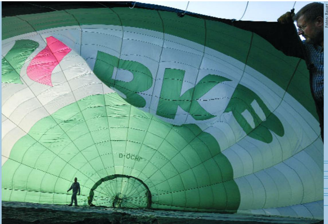
Ein Gigant der Lüfte: Mit 1.800 Quadratmeter Fläche fasst die Ballonhülle 5.100 Kubikmeter Luft.
