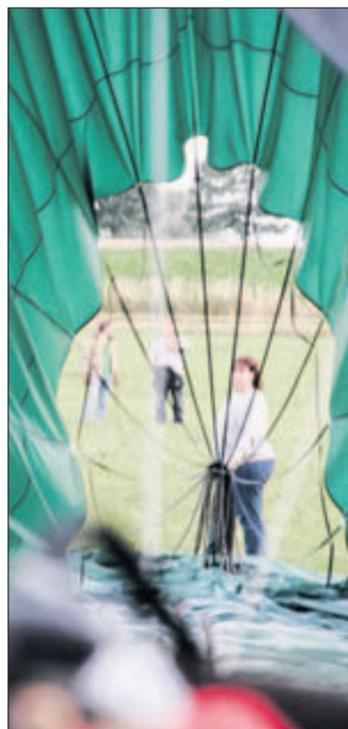
Nach der Landung strömt die Luft durch das Parashout-Ventil aus.
