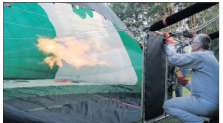
Jetzt wird es heiß: Lorenz öffnet das Gasventil und erhitzt die Luft im Innern des noch liegenden Ballons an.
