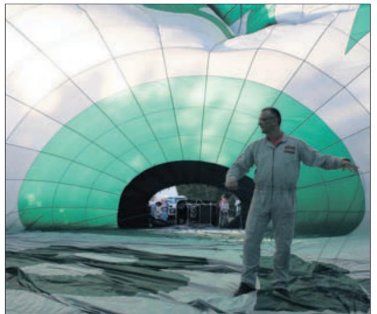
Beim Aufbau: Kalte Luft wird in den Ballon geblasen. Ingo Lorenz sortiert die Seile im Innern, damit nichts verknotet.
