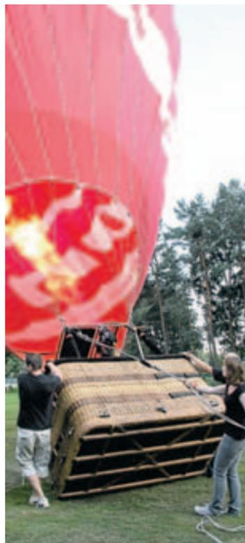
Mit vereinten Kräften wird der Ballon auf einer Wiese am Tankumsee aufgerichtet. 5100 Kubikmeter Luftinhalt werden von 1500 Quadratmetern Stoff und 10 Kilometern Garn umspannt. Wert: 90 000 Euro.
