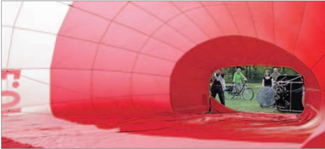
Ein Blick aus dem Inneren der Ballonhülle, während sie von draußen mithilfe eines Ventilators aufgeblasen wird.
