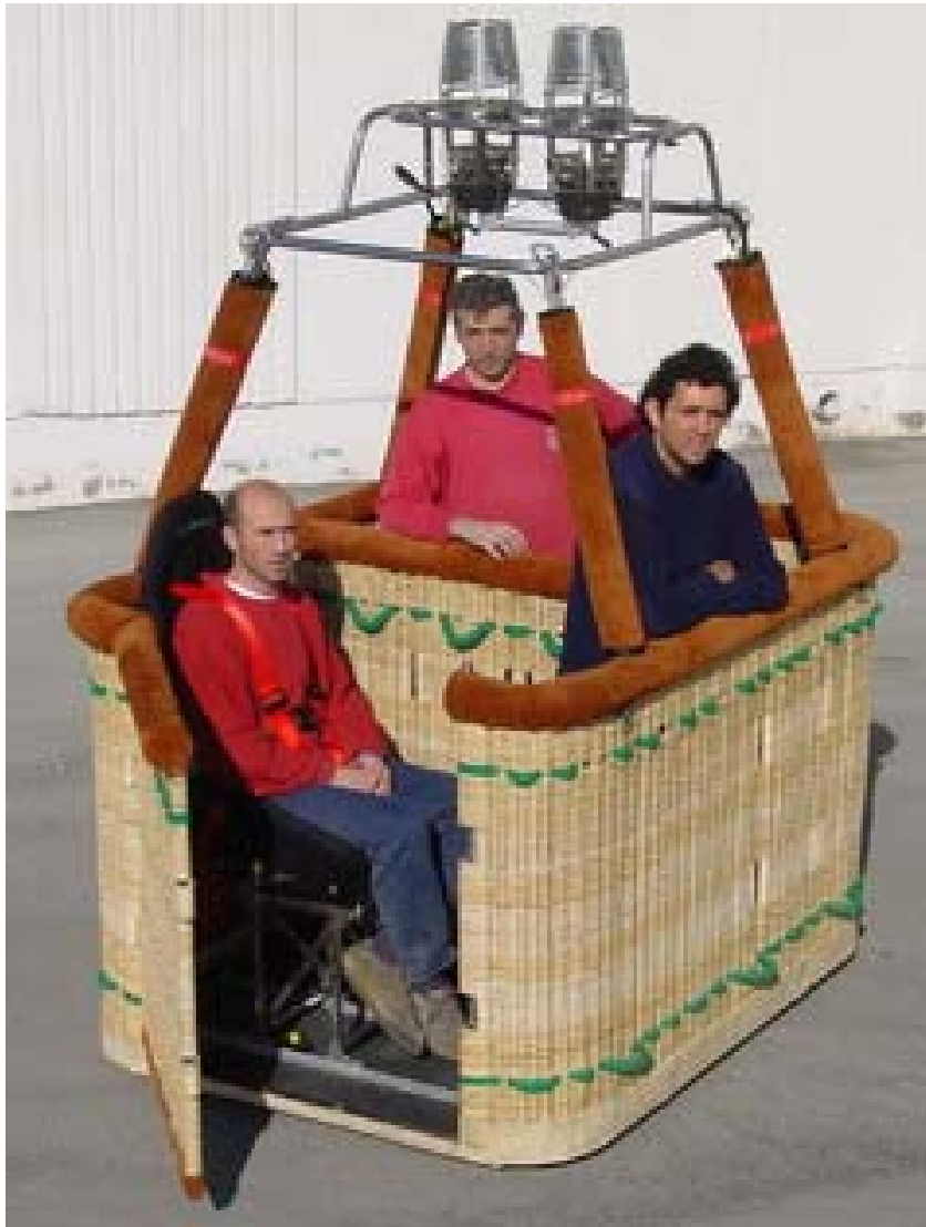
Der umgebaute Ballonkorb mit Tür und Spezialsitz © Ultra Magic
