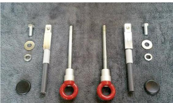
Einem einseitigen Verzug des Vorderwagens wird so schon einmal nachhaltig entgegengewirkt. Zum Vergleich, die originale Öse ist für 30 kN (rund 3 t) ausgelegt. Die verstärkten Ösen können pro Stück 90 kN vertragen. Der Preis liegt zum Beispiel für die T5 Version bei 380 Euro
